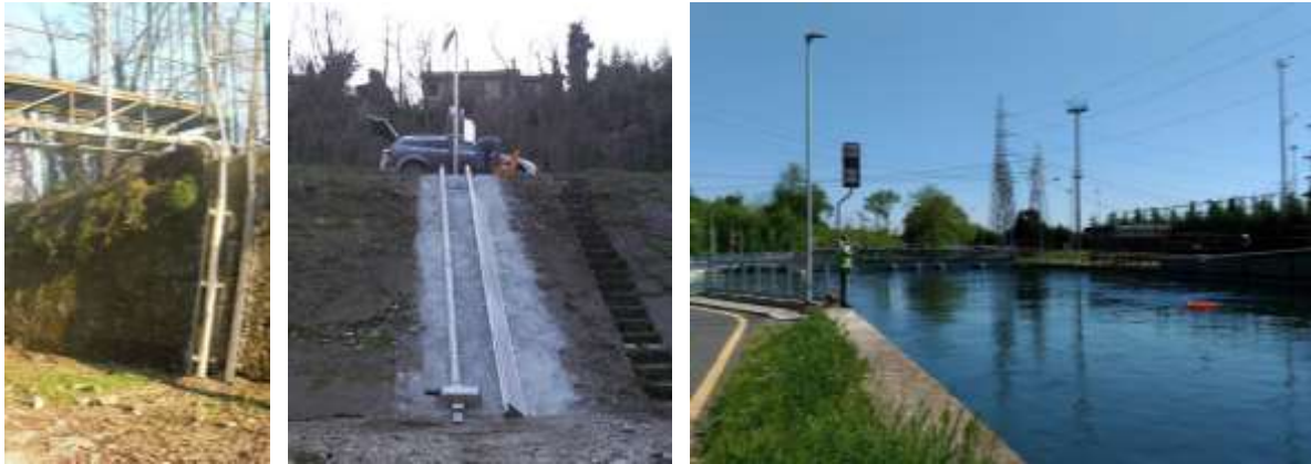
Figura 87 – Stazioni di misura di portata derivata nel N. Martesana a San Bartolomeo (sinistra) e nel Canale Villoresi a Vizzola (centro); misura di portata mediante profilatore ADCP RioGrande per taratura stazione nel N. Grande a Turbigo (destra).
